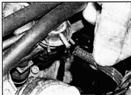
Рис. 4.38. Отсоедините вакуумный шланг от регулятора давления топлива
