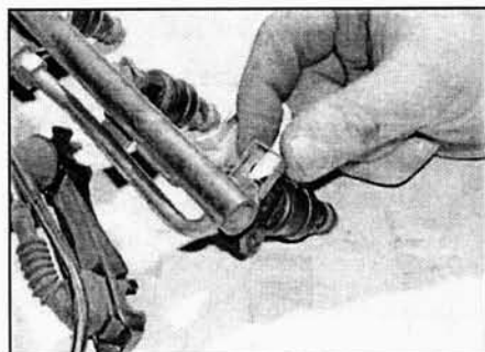
Рис. 4.35,а. Выньте фиксаторы...
